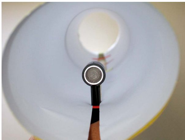
Figure 2 - Tube en papier utilisé pour canaliser le flux d'air généré par un ventilateur. Le récepteur peut être déplacé dans le tube en couissant dans l'échancrure. L'émetteur, non visible sur la photo, est aussi placé dans ce tube.
