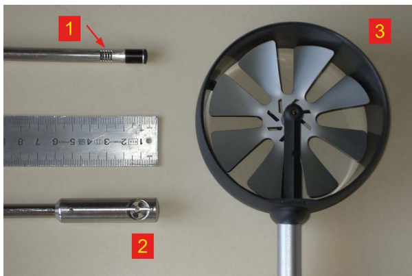
Figure 1 - Exemples de sondes d'anémomètres. 1 Anémomètre à fil chaud (la résistance est au bout de la flèche) ; 2 et 3 Anémomètre à pales.
