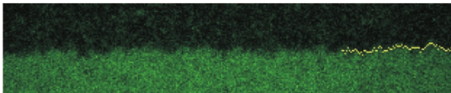
FIGURE 1 – Photographie d'une interface colloïdale tiré de l'article, l'équivalent du liquide est coloré et situé en bas ; l'équivalent du gaz est plus sombre et situé en haut.
