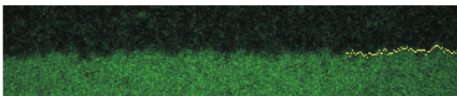
FIGURE 2 – Photographie d'une interface colloïdale tiré de l'article, l'équivalent du liquide est coloré et situé en bas ; l'équivalent du gaz est plus sombre et situé en haut.
